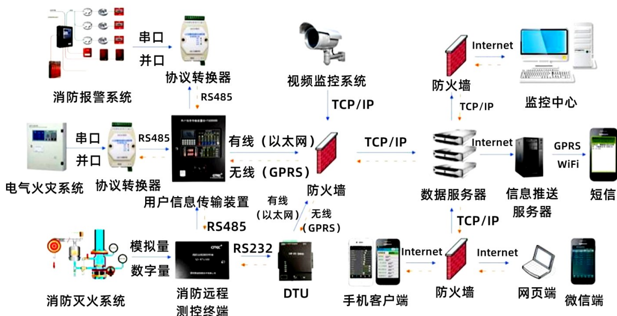
图3 消防设施状态实时监测系统图
